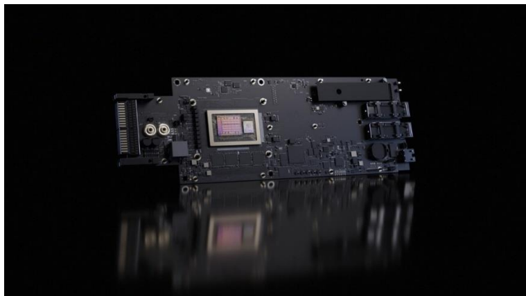
图表10: 英伟达 CMX Context Memory Storage Platform 由 DPU 管理, 可以承接低频访问的 KV cache
