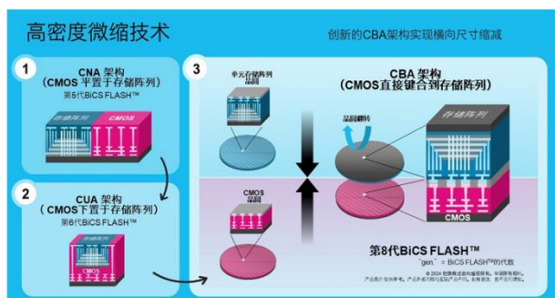
图表 57: 铠侠的 CBA 技术示意图
